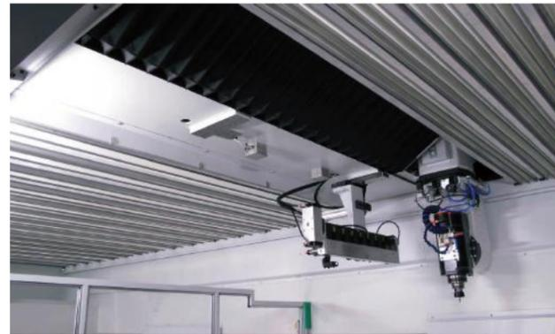
Chiusura superiore per il contenimento delle polveri
