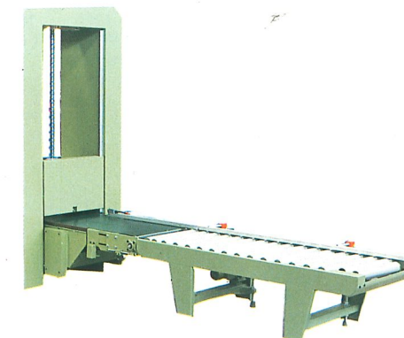
Rollenbahn mit schräggestellten Rollen zur Verbindung zwischen Montagestrasse und Korpuspresse.
