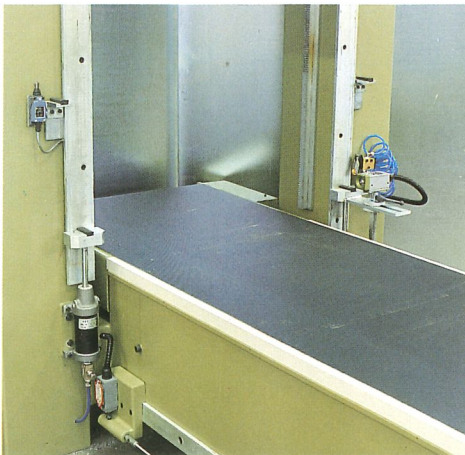
Pneumatikvorrichtung für Korpuse mit Sockel.
