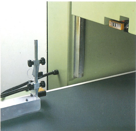
Vieffache Photozellen zum Erkennen der Länge und Höhe bei Spezialkorpussen.
