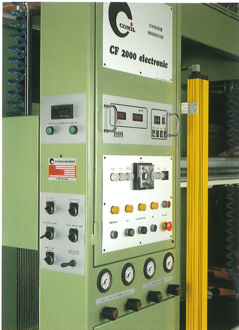
Zusätzliche Steuerung für raschen Druckwechsel und für Spezialaggregate.
