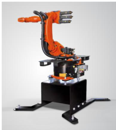
Macchina predisposta per l'installazione di **pistole o robot antropomorfo** per l'aggraffaggio.
