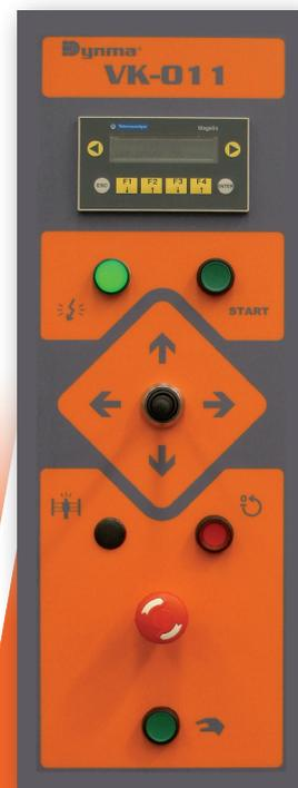
Panel de mando de fácil manejo con "joystick" para el ajuste rápido de los planos de apriete y pantalla de programación que permite seleccionar la fuerza de prensado, modo de apriete, duración del prensado y gestión de alarmas.
