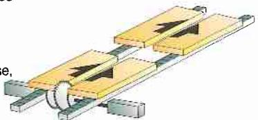
**13. Prolongateur d'arbre.** Il permet de travailler entre les chaînes pour effectuer des rainures sous un panneau ou le couper. Pour cela, une petite fenêtre est ouverte dans les tables des chaînes, en face de la toupie qui en sera équipée.
