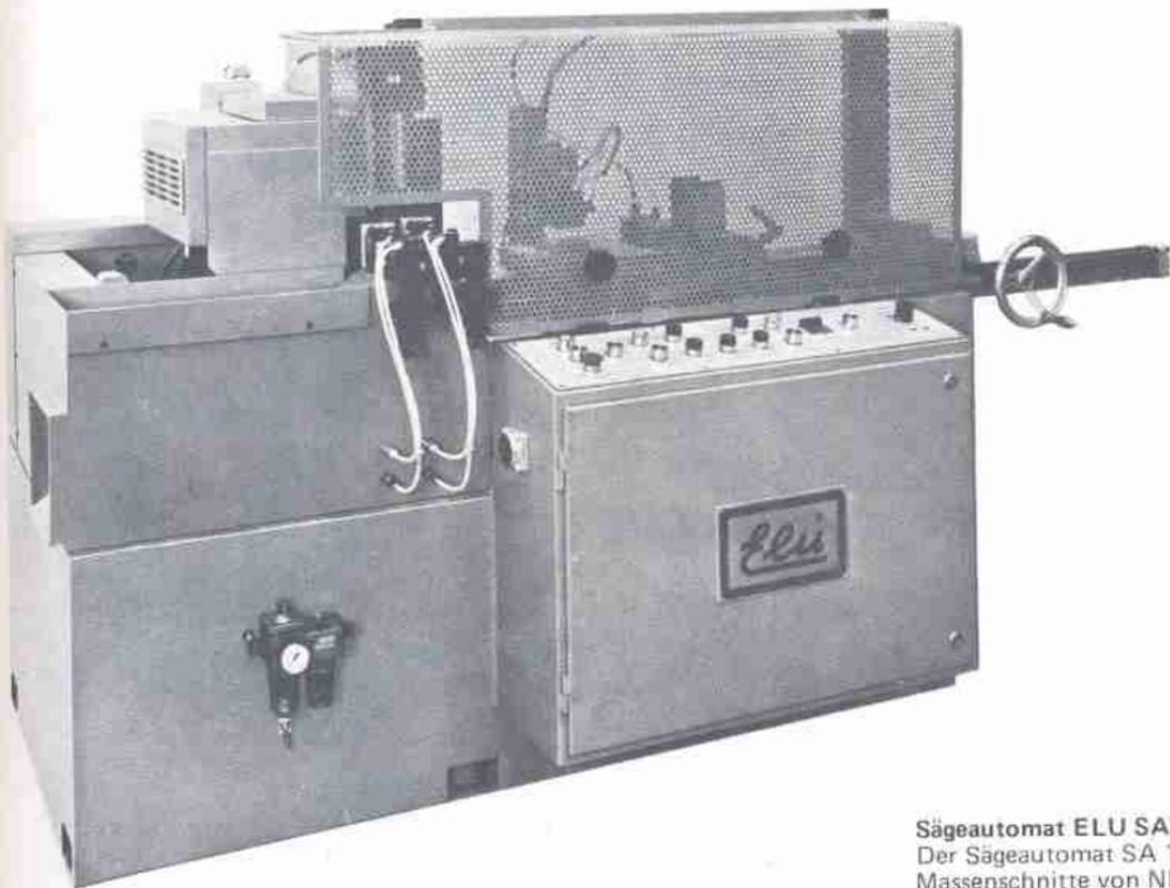
Technische Daten: Drehstrommotor 220/380 V, Abgabeleistung 3 kW, Sägeblatt- $\phi$  420 mm, Sägeblattdrehzahl 2800 U/min, Schnittbereich 96x200 mm, Vorschublänge 5 - 1200 mm
