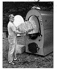
Die Beschickung mit Strohballen bei bereits brennendem Kessel darf aber nur von einem geübten Bediener ausgeführt werden, unter Beachtung der Regeln zum Brand- und Arbeitsschutz.
