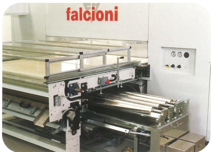
**I** L'overspray si deposita in gran parte sul tappeto che viene poi raclato e pulito in automatico con un sistema brevettato a rulli controrotanti che determina i seguenti vantaggi:
