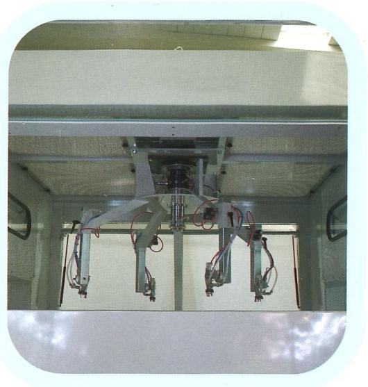
**C** La spruzzatrice automatica può essere fornita, in funzione delle esigenze del cliente, con reciprocatore centrale o con pistole rotanti particolarmente indicate per l'applicazione di tinte o patine.
