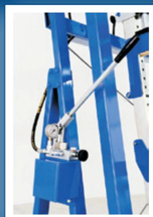
Kraftvolle Presseeinheiten: dickwandiges Hohlprofil mit Präzisionslochraster, voll verzinkt
