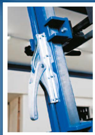
Kraftvolle Presseeinheiten: dickwandiges Hohlprofil mit Präzisionslochraaster, voll verzinkt
