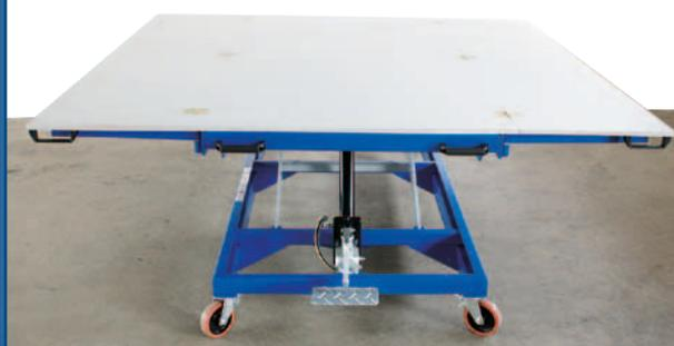
Ausklappbare Auflage zur Erweiterung der Arbeitsfläche
