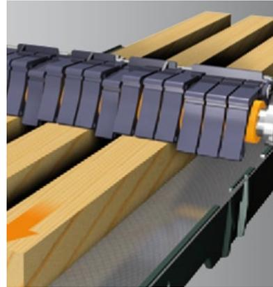
Auf Wunsch: Glieder-Druckbalken in Kombination mit Gummi-Einzugswalze für gleichzeitiges Bearbeiten unterschiedlich dicker Hölzer.
