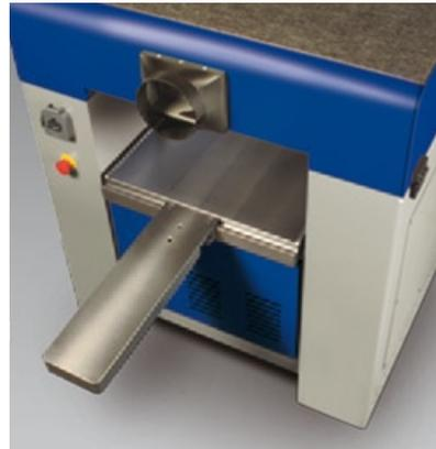
Zusätzlich zu der beachtlichen Länge von 900 mm kann der Dickentisch mit einer Werkstück-Auflagerolle und auf der Abnahmeseite mit Tischverlängerungen flexibel erweitert werden. Die Gesamt-Auflagefläche können Sie so auf 1500 mm erweitern.
