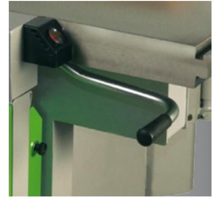
Präzise und bequem erfolgt die Schnelleinstellung der Spanabnahme am zuführenden Abrichttisch von der Bedienseite aus.
