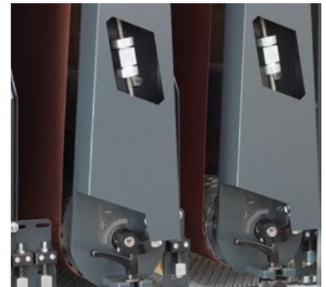
**Pneumatische Auswahl der Kontaktwalzen**
