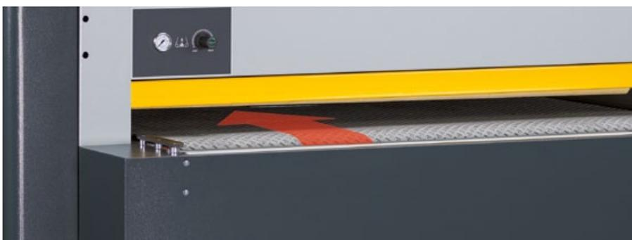
Serienmäßig kann die Vorschubgeschwindigkeit am Bedienfeld stufenlos zwischen 2,8–20 m/min geregelt werden.
