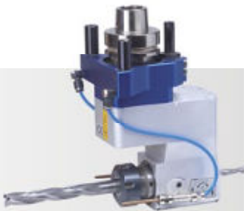
HSK F63 Schlosskastenaggregat mit 1 Ausgang ER 32 für Bohr- oder Fräswerkzeug mit zwei Druckluftausblasdüsen und 1 Ausgang hinten ER 16 für Bohr- oder Fräswerkzeug Best.-Nr. 300-24-017 Best.-Nr. 300-24-038 (H08 21-31P)
