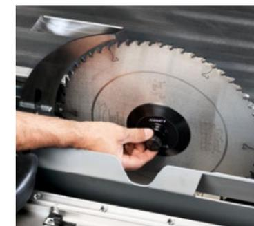
**Werkzeugloser Sägeblattwechsel „Easy-Lock“ – nur bei Format4!**
