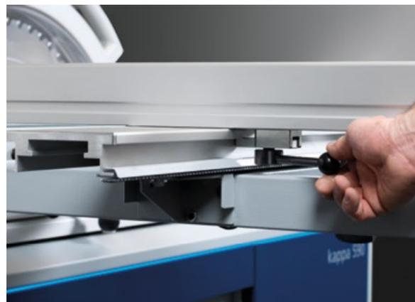
**Noch flexibler – Ergonomischer Arretierhebel am Ablänganschlag**
