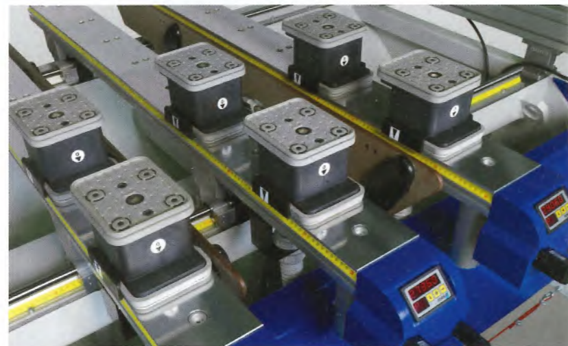
Mitfahrender Kreuzlaser zur exakten Konsolen und Vakuumsaugerpositionierung.
