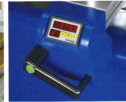
Optional: Digitalanzeige für Positionierung der Werkstückauflagen in X-Richtung und der Vakuumsauger in Y-Richtung, entsprechend den in der Software gewählten Positionen.
