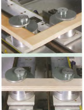
Optional: Digitalanzeige für Positionierung der Werkstückauflagen in X-Richtung und der Vakuumsauger in Y-Richtung, entsprechend den in der Software gewählten Positionen.
