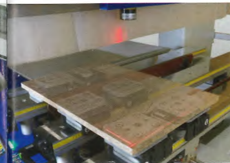
Mitfahrender Kreuzlaser zur exakten Konsolen und Vakuumsaugerpositionierung.
