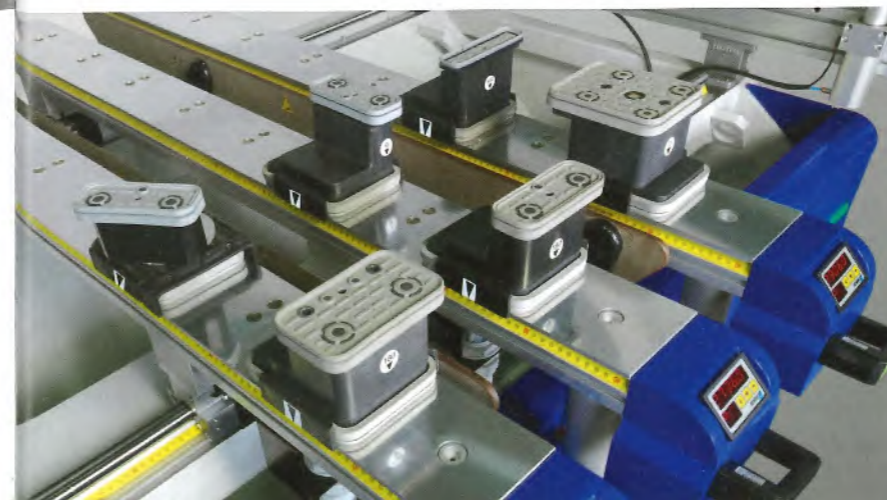
Mitfahrender Kreuzlaser zur exakten Konsolen und Vakuumsaugerpositionierung.
