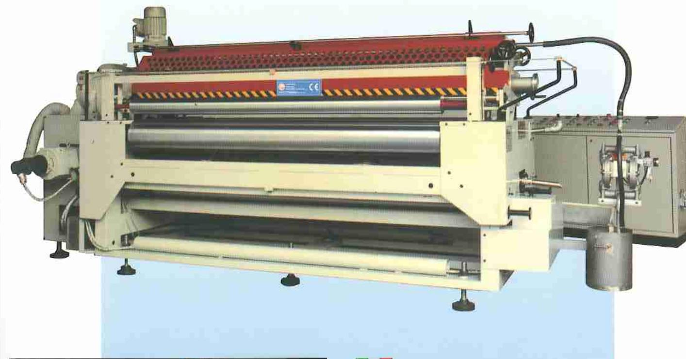
Versione speciale verniciatrice a rulli per grandi dimensioni 2200 mm. Questa macchina è munita di speciali apparecchiature elettroniche che le permettono di essere sincronizzata con altre macchine nella stessa linea e può facilmente vernicare sia nastri in continuo che fogli singoli.
