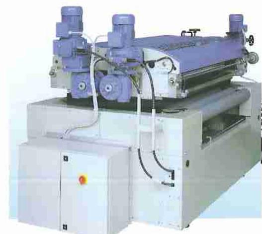
Adatta per l'applicazione di stucchi UV ad alta viscosità. Per mezzo del rullo spatolatore revers in acciaio di grande diametro permette di schiacciare nelle porosità dei supporti (truciolare, nodi, giunture, screpolature) lo stucco UV.
