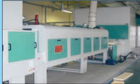
Linea di verniciatura pannelli sagomati con SPRUZZATRICE • Finishing line for shaped panels by SPRAYING MACHINE • Ligne de finition panneaux moulurés avec PULVÉRISATRICE • Fertigungsstraße für profilierte Teile mit SPRITZMASCHINE • Línea de barnizado de paneles moldurados -plafonados con PISTOLAS
