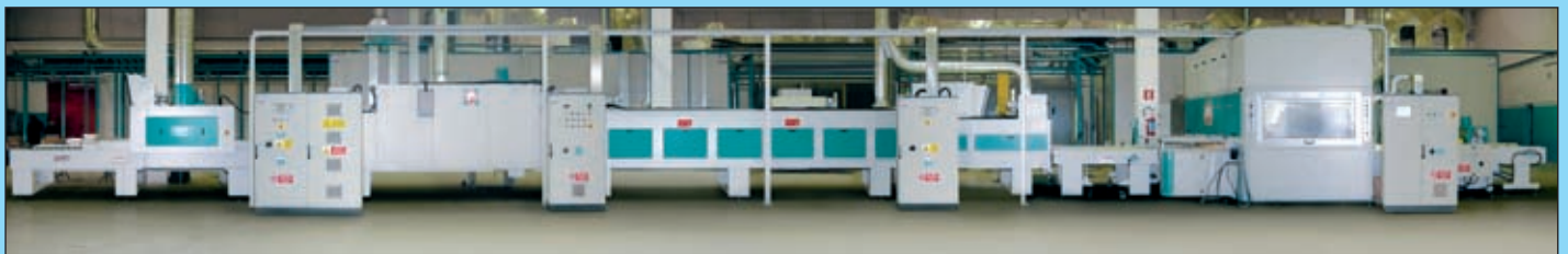
Linea di verniciatura antine con SPRUZZATRICE • Finishing line for kitchen cabinets by SPRAYING MACHINE • Ligne de finition portes de cabinets avec pulvérisatrice • Fertigungsstraße für profilierte Teile mit SPRITZMASCHINE • Línea de barnizado mediante PISTOLAS.
