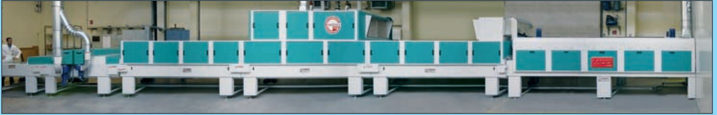
Linea di verniciatura antine con SPRUZZATRICE • Finishing line for cabinets by SPRAYING MACHINE • Fertigungsstraße für Fachtüren mit SPRITZMASCHINE • Línea de barnizado de puertas de cocina mediante PISTOLAS • Ligne de finition portes de cabinets avec PULVÉRISATRICE.
