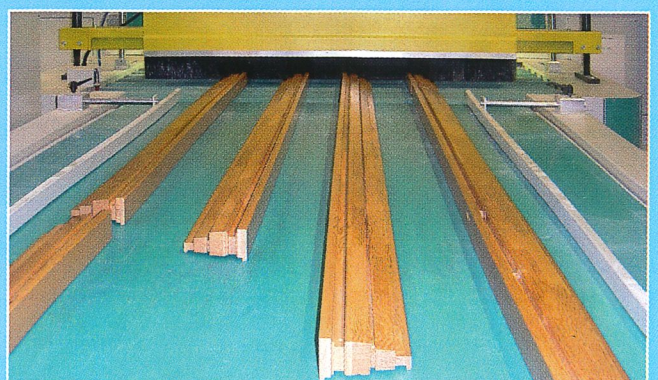
Abb.5 - Einlauf in die Werkstückreinigungsmaschine
