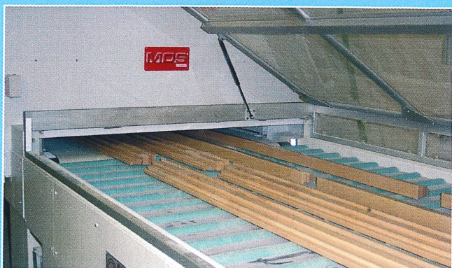
Abb.8 - Einlauf der lackierten Werkstücke im MOS® für die erste Trocknung
