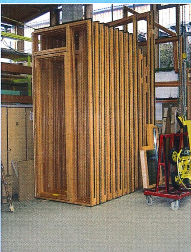
Abb.15- Lackierte und montierte Fenster und Türen, fertig zum Versand
