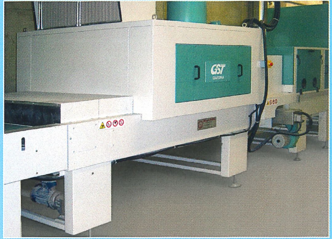
Abb.11 - Letzte Trocknung mit UV/3D Trockner
