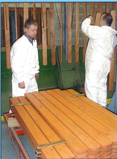
Abb.14 -Ausladung der lackierten Werkstücke
