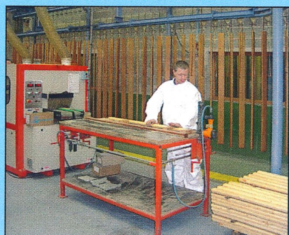
Abb.3 - Schleifen und Verklammerung der Rohwerkstücke
