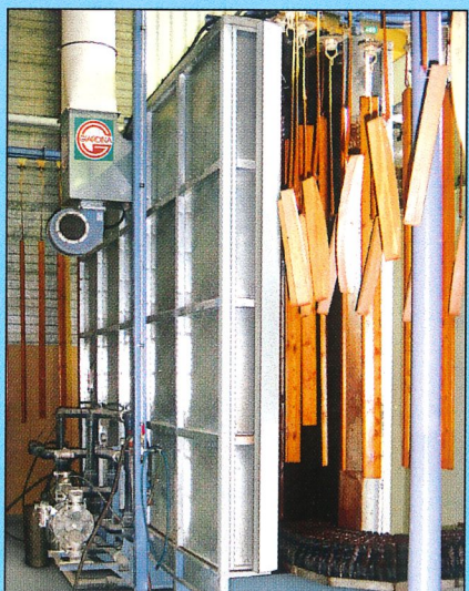
Abb.6 - Imprägnierung- Applikation mit Flow Coating
