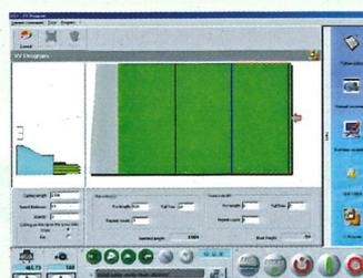
Die Durchführung des Schnittplanzyklus wird gleichzeitig während der Abarbeitung auf der Maschine auf dem Monitor angezeigt und der Bediener wird somit graphisch in Echtzeit durch die einzelnen Schnittsequenzen geführt.
