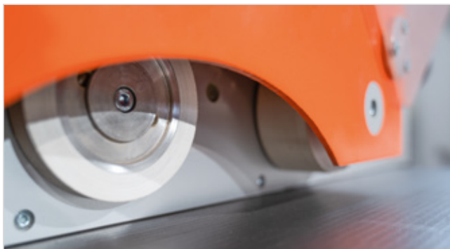
Kreissägen-Vorschubapparat 76: Vorschubrollen im Detail
