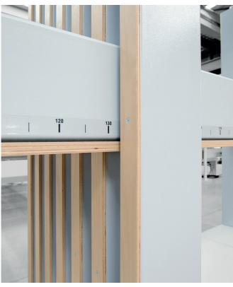
Pressflächen mit Toleranzausgleich: Die Presslamellen funktionieren wie eine Einheit, sie sind auf Gummis gelagert und abgefedert. Durch das zeitgleiche Auftreffen der Presslamellen auf den Korpus wird der Druck besonders gleichmäßig verteilt. Toleranzen im Korpus werden besser aufgefangen.
