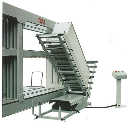
Für die Manipulation größerer Korpusse wird die **Auslaufrollenbahn** mit der **Aufrichtstation** kombiniert. Mittels Spindeltrieb wird der Korpus aufgerichtet, der dann bequem weiter transportiert werden kann.
