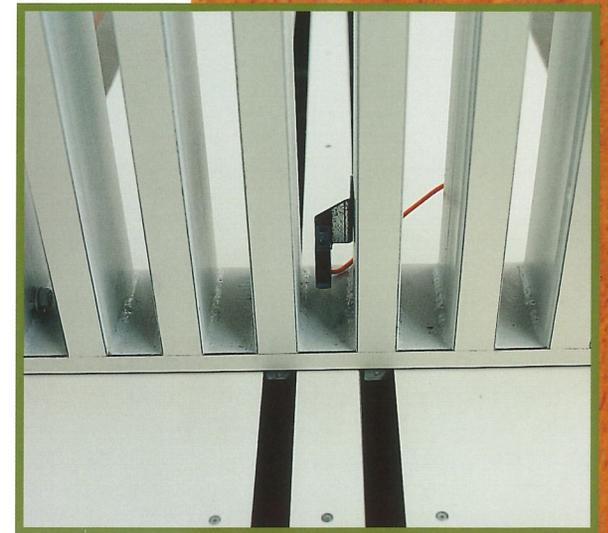
Ein in den Druckwänden integrierter **elektronischer Sensor** erkennt den Korpus und steuert die Bewegungs- und Pressabläufe.
