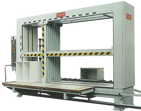
Korpuspresse Koptronik mit **Maschinenfüßen** für ergonomisch günstige Arbeitshöhen und seitlich verschiebbaren **Vormontagetisch** mit pneumatisch heb- und senkbaren Rollengängen
