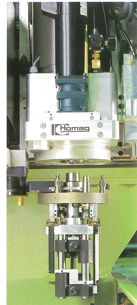
Hauptspindel mit universeller Schnittstelle.
