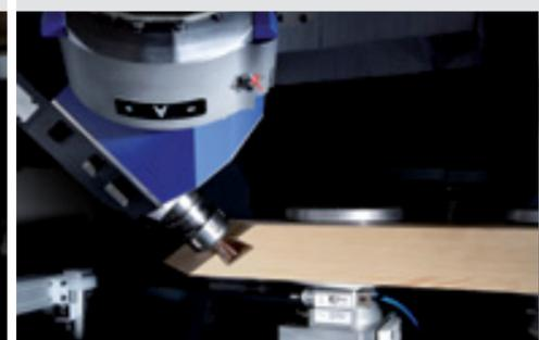
Fraisage assemblage biais pour poteaux/montants
