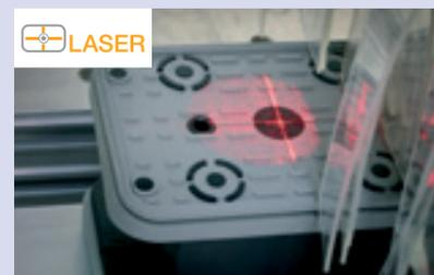
Les ventouses sont affichées à l'aide d'un trait laser (laser en croix). Le contour des pièces peut être „parcouru“ pour aider au positionnement des pièces aux géométries libres.
