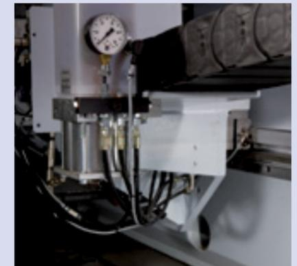
Guides linéaires recouverts avec des chariots fermés et graissage centralisé automatique intégré de tous les axes. Chaînes d'énergie fermées pour la protection des câbles et des tuyaux.
