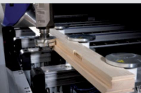
Serrage et profilage de pièces de cadres
