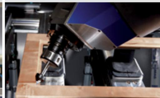
Usinage précis d'une feuillure pour l'insertion d'une vitre
