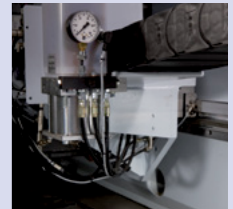
Abgedeckte Linearführungen mit geschlossenen Führungswagen und integrierter automatischer Zentralschmierung aller Achsen. Geschlossene Energieketten zum Schutz von Kabeln und Schläuchen.
