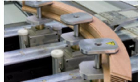
Hochsteife 3-Stufen-Spanner mit großer Spannhöhe zur präzisen Komplettbearbeitung von Fenster- und Haustürteilen ohne nachträgliches Umfälen.
