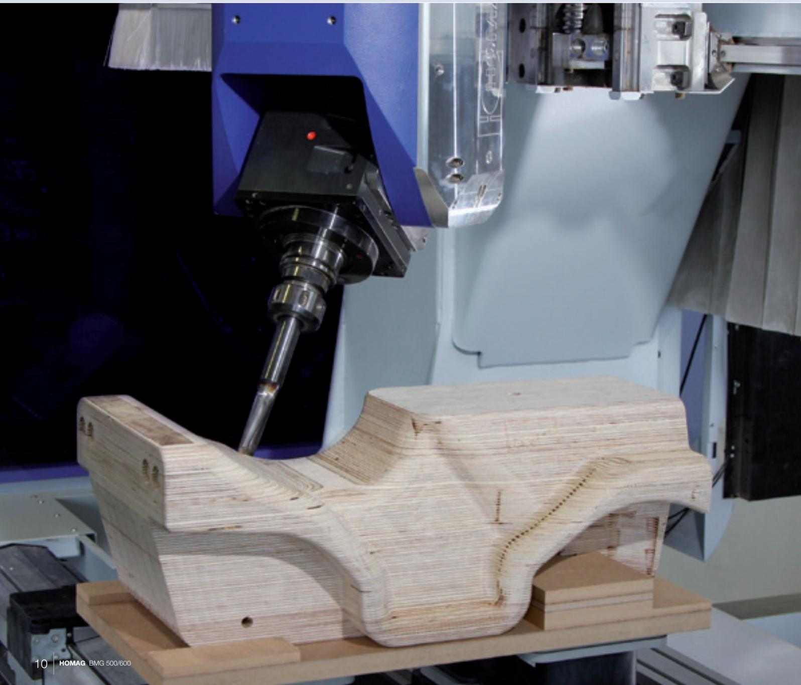
Hochwertiger Fahrzeugausbau und Komponentenfertigung zeichnen sich durch individuelle Gestaltung und eine Vielzahl an Materialien aus. Die sich daraus ergebenden Anforderungen an die Bearbeitungszentren wie z. B. Fünf-Achs-Technik für gewölbte Fronten oder Fräswerkzeugkühlungen für die Acrylbearbeitung decken HOMAG Bearbeitungszentren ab. Somit sind Ihnen auch in Zukunft „keine“ Grenzen gesetzt im Bezug auf:
