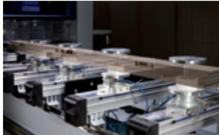
Manuelle Spannvorrichtung **powerClamp** für gerade und geschweifte Teile. Ideal für alle Bogen-, Schmal- und Rahmenteile.
