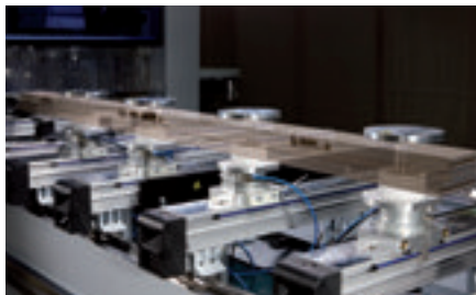
Dispositif de serrage manuel powerClamp pour les pièces droites et cintrées. Idéal pour les pièces courbes, étroites et les pièces de cadre.
