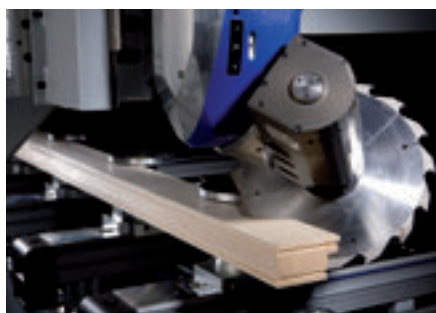
Coupes en biais précises même pour les matériaux de grande épaisseur.
