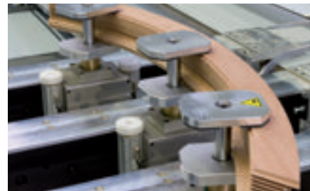
Éléments de serrage rigides à 3 niveaux avec une hauteur de serrage importante pour l'usinage complet précis de pièces de fenêtres et de portes sans détournage ultérieur.
