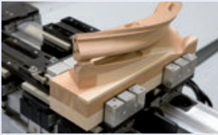
Élément de serrage horizontal pour la fixation fiable de limons de mains courantes.
