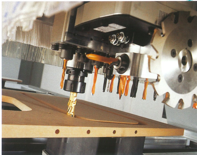
Fräsen eines Treppenkrümmlings mit einwechselbarem 5-Achs-Aggregat
