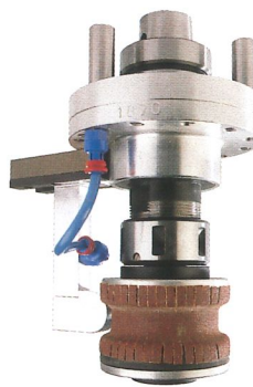
Aufnahme für Schleifscheiben. Für Schleifarbeiten, z.B. an Massivholz. Die Schleifkörper werden über eine Abblasdüse kontinuierlich mit Druckluft gereinigt
