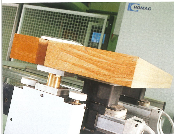
Kombination von schlauchlosen, frei verschiebbaren Vakuumspannern und pneumatischen 3-Stufen-Spannern
