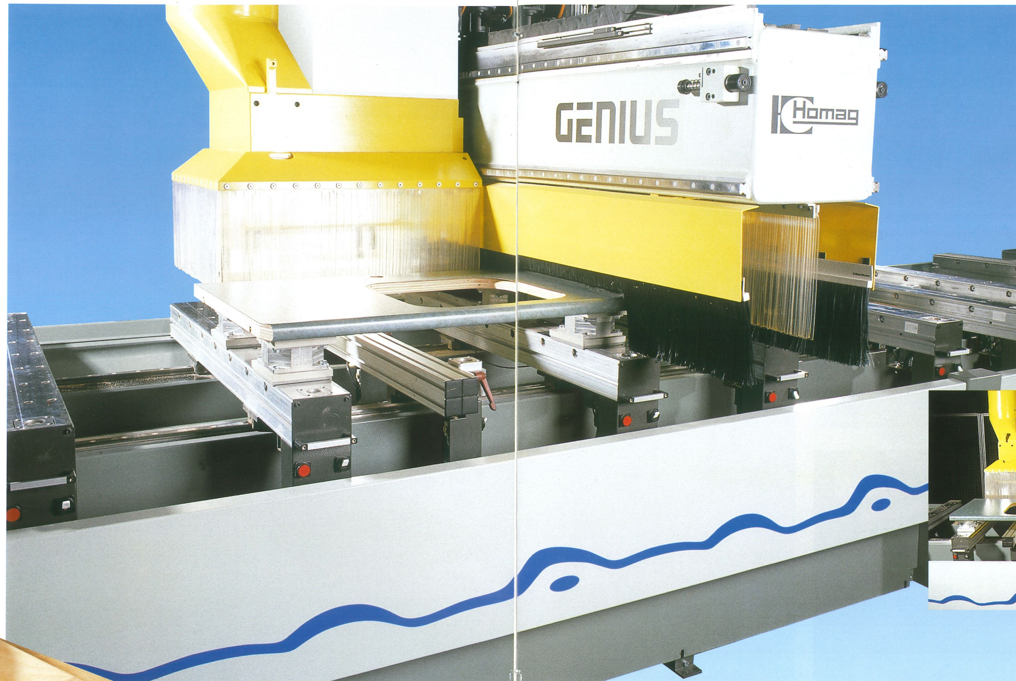
Bearbeitung von Massivholzteilen, eingespannt in eine Schablone
