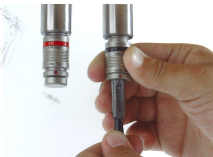
Le système breveté de changement rapide de la tête de perçage permet le remplacement des mèches sans changer l'outil.
