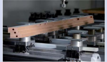
Verfahren der Pneumatikspanner nach der Längsprofilierung von z. B. Fensterkante für eine 5-seitige Bearbeitung
