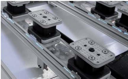
LED-Positioniersystem – das schnellste und sicherste System gegenüber allen anderen Systemen zum manuellen Positionieren der Vakuumspanner und Konsolen
