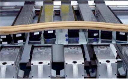
Durch das Maxi-Flex-Spannsystem entsteht eine durchgängige Ebene zur beliebigen Spannmittepositionierung
