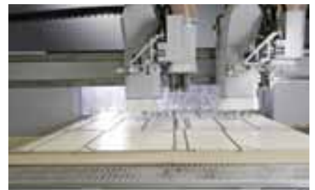
Usinage synchrone pour le Nesting de pièces de corps de meubles
