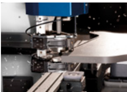
Perfektes Kantenfinish durch getastetes Kombi-Bündigräs-/ Nachputzaggregat
