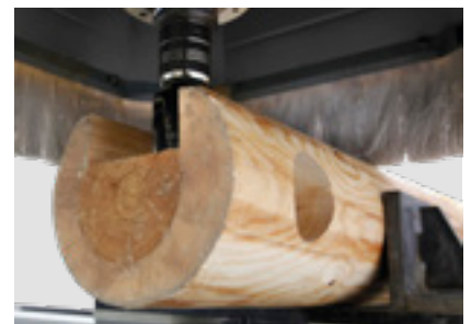
Blockspanner: Angepasste Blockspannvorrichtung für Rundholzelemente.
