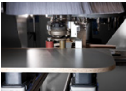
Verleimaggregat easyEdge zum rationellen Anleimen an Formteile
