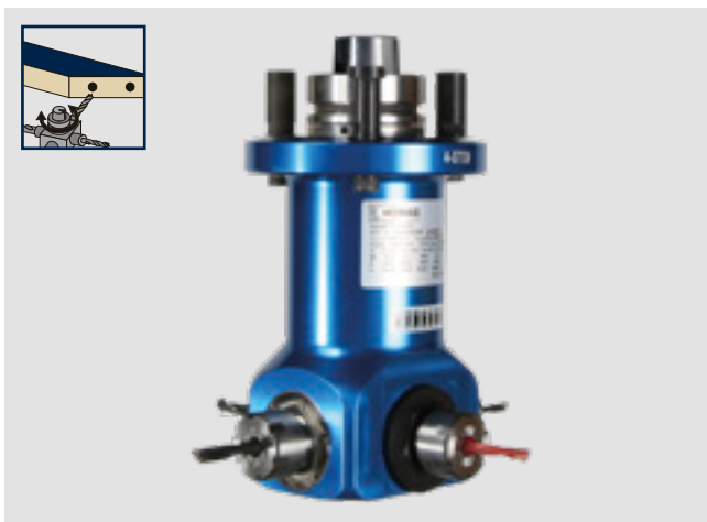
Bohr-/Fräsaggregat, 2+2 Spindeln: Durch den 4-seitigen Spindelaustritt stehen vier unterschiedliche Bohr- und Fräswerkzeuge ohne einen Werkzeugwechsel zur Verfügung. Durchgehende Welle für höhere Steifigkeit und die Bearbeitung ohne Drehrichtungswechsel bei Einsatz von rechts- und linksdrehenden Werkzeugen, z.B. für Ausfräsungen für Türbänder.
