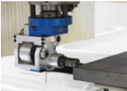
Getastetes Bündigräsen der Kantenüberstände am Postformingprofil
