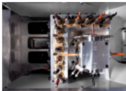
Bohrkopf V12/H4: HIGH-SPEED Bohrkopf bis 7500 1/min mit 12 Vertikalspindeln, Nutsäge und 4 Horizontalspindeln 0/90° schwenkbar. Schnelles Bohren inkl. Nuten in X/Y-Richtung.
