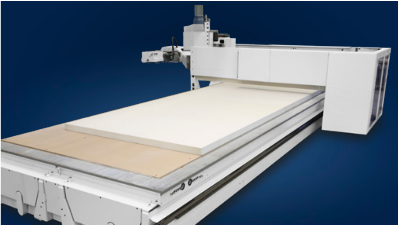
Maschinentiefe XXXL: Bauteile bis über 3 000 mm Breite für die Plattenbearbeitung für Bauelemente.
