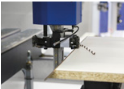
Ziehklingenbearbeitung an Gehrungskante
