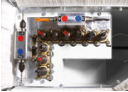
Bohrkopf V9/H4: HIGH-SPEED Bohrkopf bis 7500 1/min mit 9 Vertikalspindeln und 4 Horizontalspindeln.
