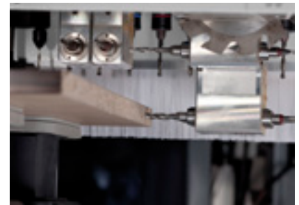
Horizontalbohrungen für Korpusverbindungen
