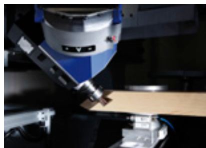
Fräsen einer Gratverbindung für Pfosten-/Riegelkonstruktionen
