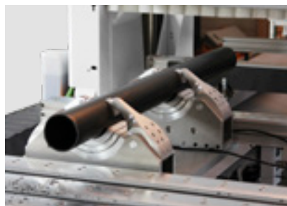
Spannvorrichtung für Rundrohre: Spannvorrichtung für die 5-Achs-Bearbeitung von Kunststoff-Rundrohren.
