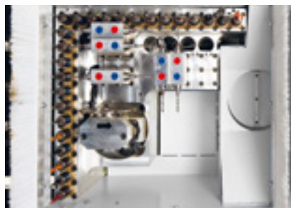
Bohrkopf V25/H10: HIGH-SPEED Bohrkopf bis 7500 1/min mit 25 Vertikalspindeln, 6 Horizontalspindeln in X- und 4 in Y-Richtung inkl. Nuten in X-Richtung.
