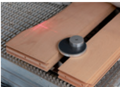
Laser di posizionamento per il posizionamento preciso delle ventose
