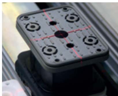
Aiuto di posizionamento con laser pin La posizione delle ventose viene visualizzata con un raggio Laser (a croce). Come ausilio di posizionamento per pezzi sagomati è possibile far visualizzare al laser il perimetro del pezzo.
