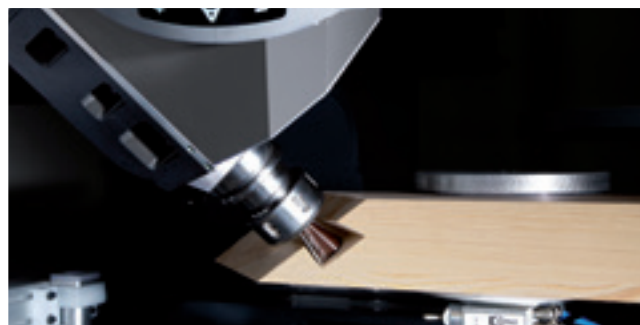
Frezowanie połączenia na jaskółczy ogon na belkach pionowych i konstrukcjach ramiakowych
