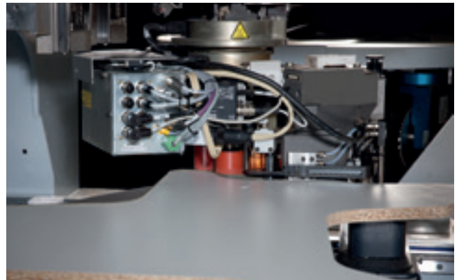
360° Kantenverleimung mit dem powerEdge Kantenanleimaggregat
