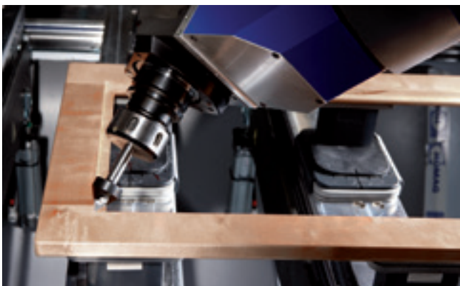
Eckiges Ausspitzen einer Glasfalz-Ecke
