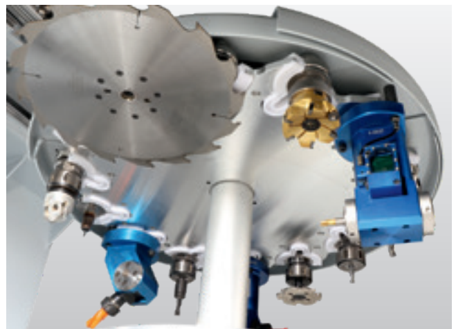
14-fach Tellerwechsler für Werkzeuge und Aggregate mit einem Durchmesser von bis zu 200 mm und Sägeblatt mit bis zu 350 mm Durchmesser.
