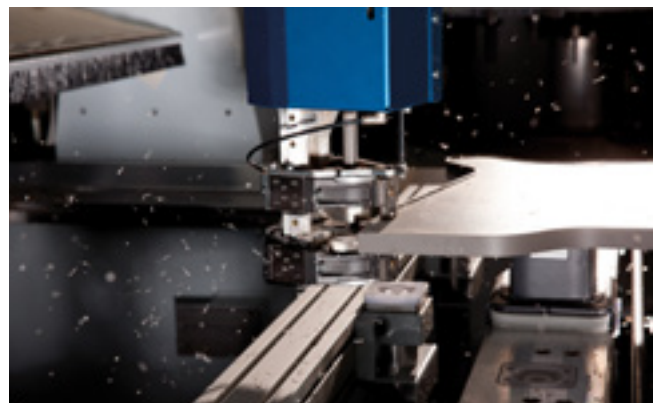
Perfektes Kantenfinish durch getastetes Kombi-Bündigfräs-/Nachputzaggregat
