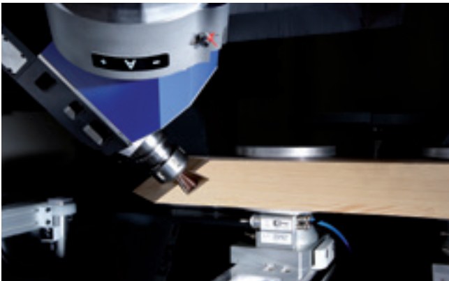
Fräsen einer Gratverbindung für Pfosten-/Riegelkonstruktionen
