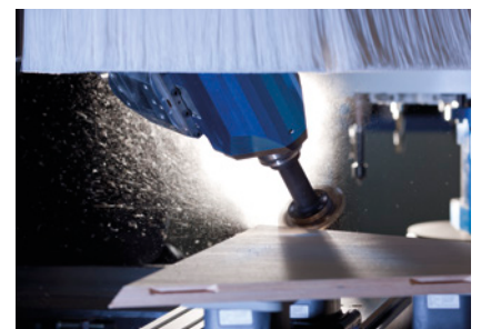
Fräsen schräger Nuten für eine Plattenverbindung
