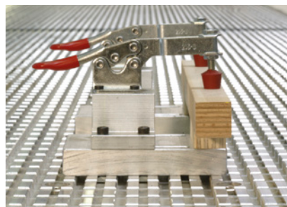
Befestigung von Sonderspannmitteln: Der Aluminiumrastertisch mit Schwalbenschwanzführungen gewährleistet die präzise formschlüssige Spannelementfixierung.
