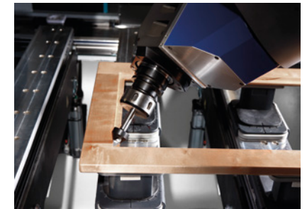
Eckiges Ausspitzen einer Glasfalz- Ecke
