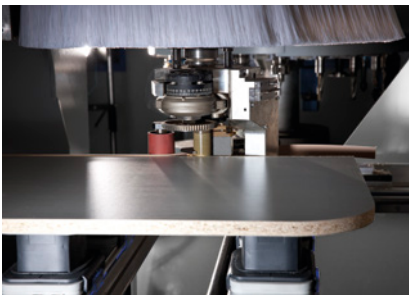
Verleimaggregat easyEdge zum rationellen Anleimen an Formteile
