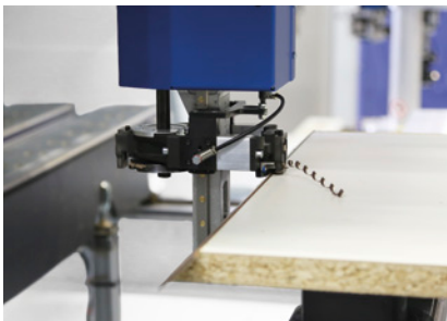
Ziehklingenbearbeitung an Gehrungskante
