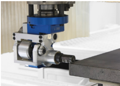
Getastetes Bündigfräsen der Kantenüberstände am Postformingprofil
