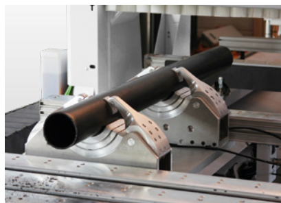
Spannvorrichtung für Rundrohre: Spannvorrichtung für die 5-Achs-Bearbeitung von Kunststoff-Rundrohren.
