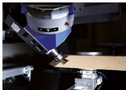
Fräsen einer Gratverbindung für Pfosten-/Riegelkonstruktionen
