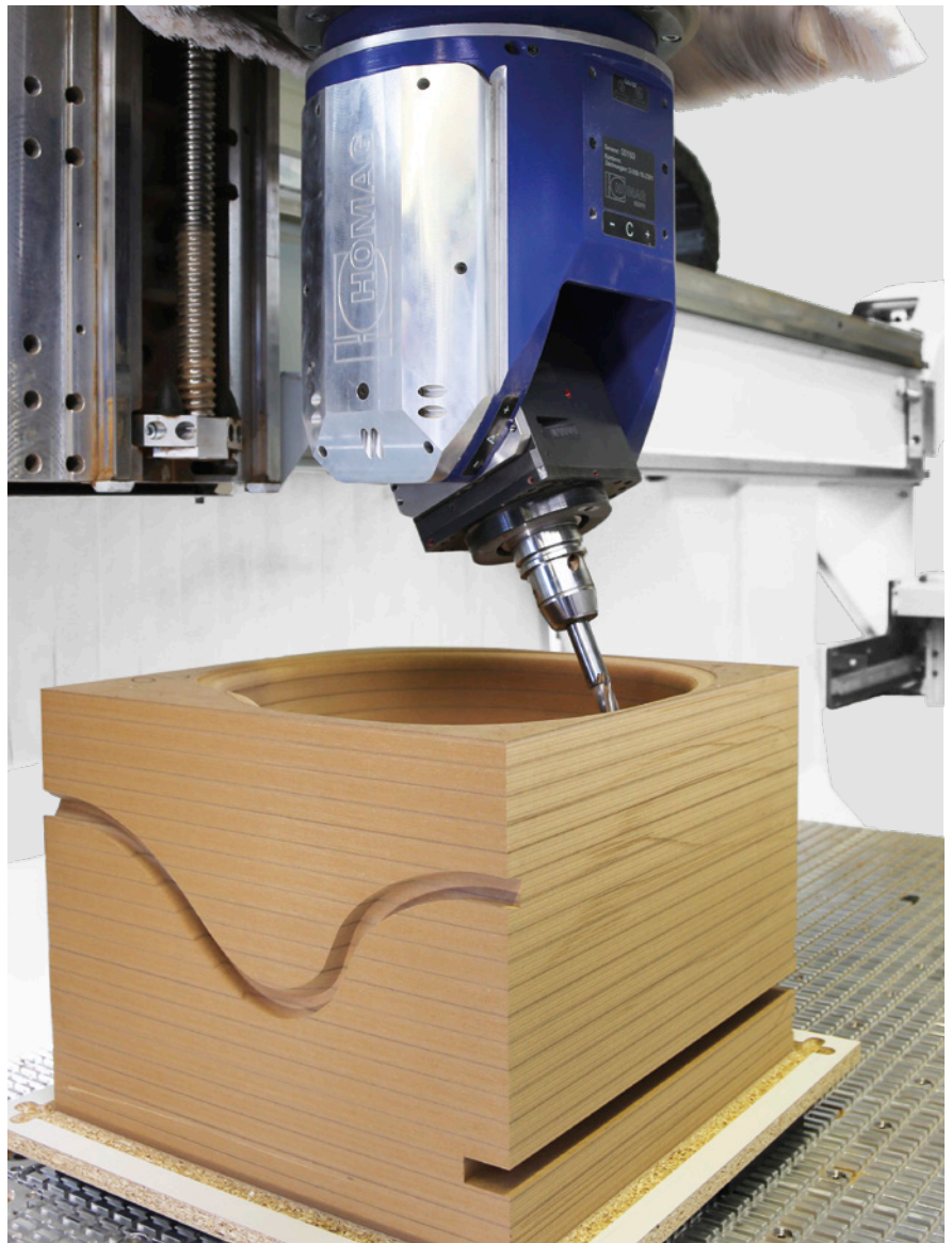
Fräsbearbeitung von Bauteilen mit großer Z- Höhe
