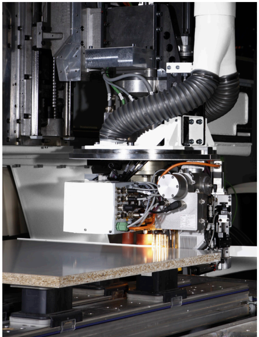
laserTec Formteilebekantung mit Nullfuge
