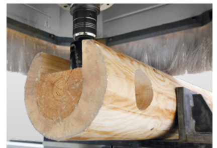
Blockspanner: Angepasste Blockspannvorrichtung für Rundholzelemente.
