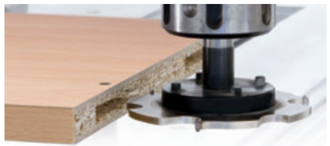
Bearbeitungen im Werkstückrandbereich für ein breites Spektrum an individuellen Verbindungsvariationen z.B. für Clamex P-Verbindungsbeschläge
