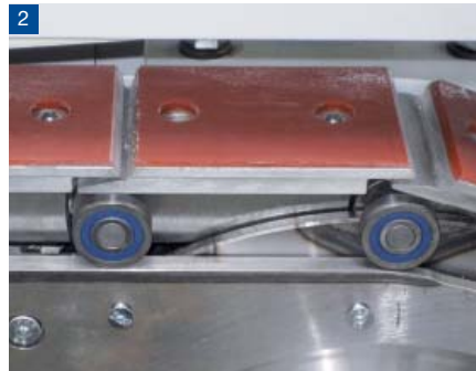
Rollende Kette (DBS-Riemen bei powerLine oder Magnetkette bei hohen Leistungen)
