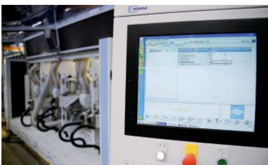
Einfach zu bedienende powerControl Steuerung nach IEC 61131 und Fernservice Fehlerdiagnose möglich
