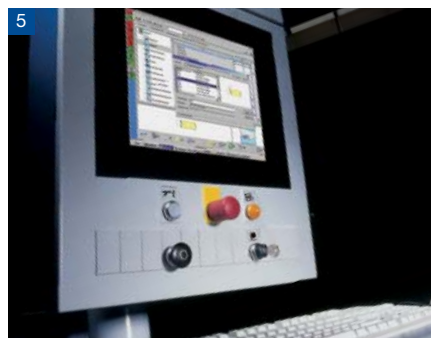
200er: Schutzsteuerung 500er/600er: powerControl Steuerung gemäß IEC 61131/3, optional: Siemens S7
