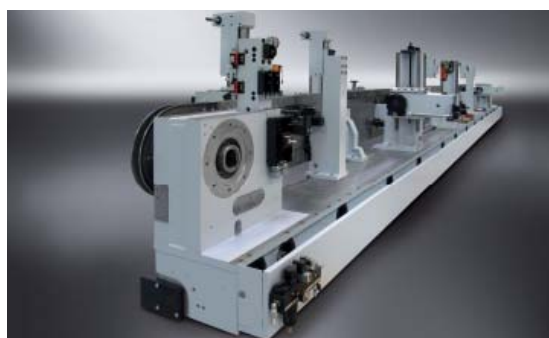
Support-Ständer zur flexiblen Bestückung mit Aggregaten auf dem Maschinenbett
