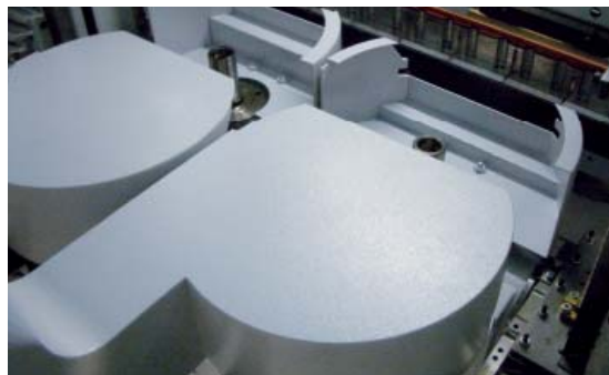
Jeder Motor mit einer an das Werkzeug angepassten Absaughaube
