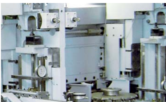
Horizontal verstellbarer Oberdruck mit digitaler Positionsanzeige
