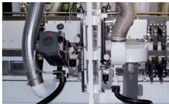
Aggregateführungen mit hochpräziser Einstellvorrichtung
