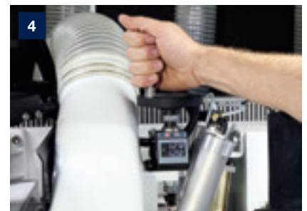
Radiale Verstellung der Druckelemente mittels elektrischer Anzeige, für automatische Anzeige und Rückkopplung des Soll-Ist-Vergleichs sowie des Korrekturfaktors
