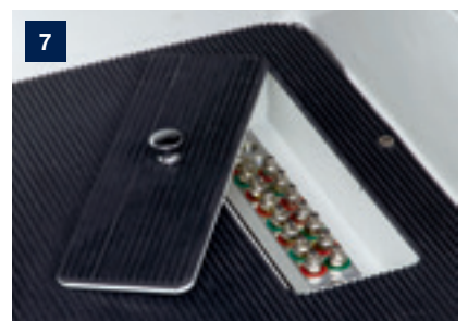
Zugängliche Zentralschmierung an der Maschinenvorderseite
