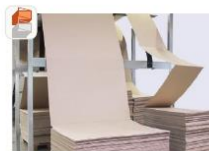
サイドバイサイド加工モードでは、パタ段のインフィード区画を巾方向に1つ追加し、それぞれの6つのインフィード区画の左右にパタ段を設置することで、最大12マガジンからパタ段を供給できるようになります。
