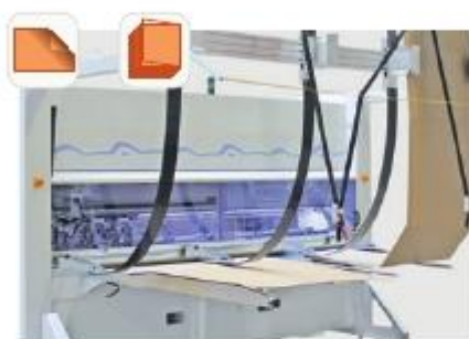
コンビネーション段ボールインフィーターにより、1枚の定尺材供給とパタ段の供給両方を投入できます。
