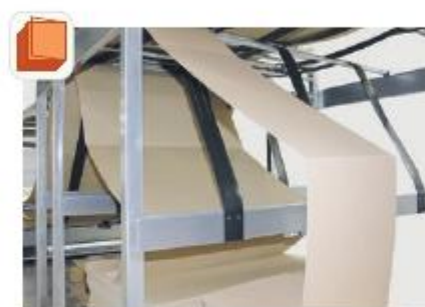
パタ段供給システムは、様々な巾のパタ段を自動で供給します。
