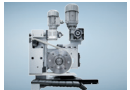
Motorisch angetriebener Oberdruck
