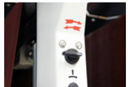
Optional Schnitttrichtung ▪ Schnitttrichtung wahlweise gegen oder mit der Vorschubrichtung. Verschiedene Schnitttrichtungen sorgen für maximale Faserreduktion. Besonders wichtig in Kombination mit Wasser basierten Lacksystemen.
