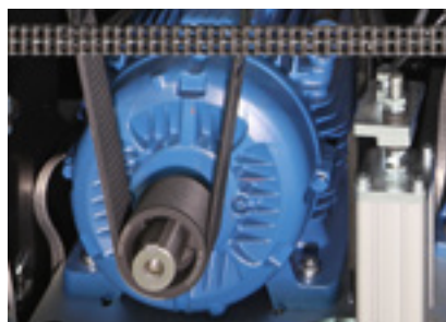
Optional Motoren zwischen 15 kW und 22 kW ▪ Je nach Anwendung und maximaler Plattenbreite (im Dauerbetrieb) Frequenzgeregelte Motoren ▪ bringen verbesserte Oberflächenqualität und Vielseitigkeit ▪ Voraussetzung für den Lackzwischen Schliff
