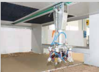
Schlittenläufer mit einem Spritzarm für vier Spritzpistolen.
