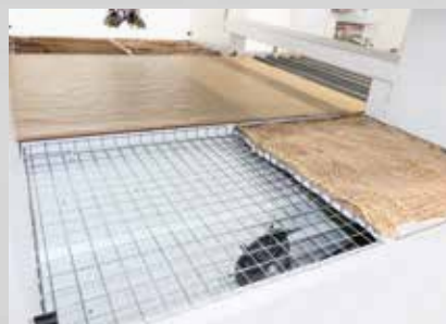
Groß dimensionierte Filter für Reinigung und Wartung einfach zugänglich und wechselbar.
