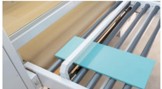
**Reconnaissance de pièces de précision :** les contours des pièces sont déterminés de façon précise à l'aide de barrières lumineuses à résolution fine. Ce qui permet une commande précise des pistolets de laquage et un gain de laque de 12-15 % par rapport aux systèmes dotés de simples cellules photoélectriques.
