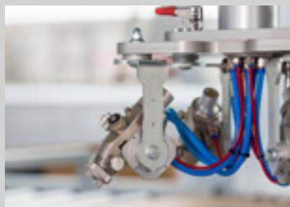
**Les pistolets de laquage** sont prémontés sur un support. Des aides au réglage précises facilitent et simplifient les opérations de réglage.
