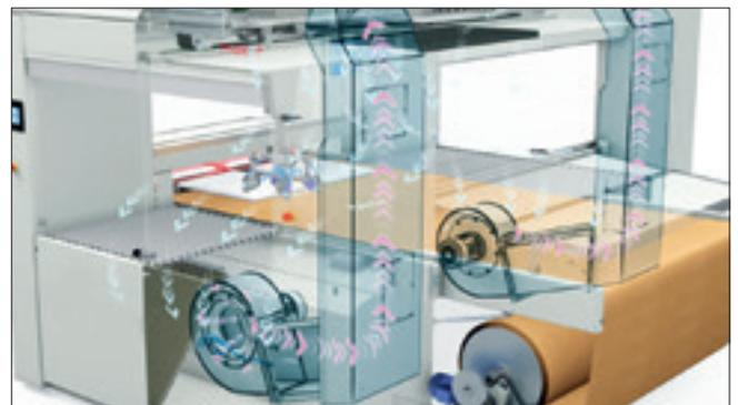
**Réduction de l'overspray :** un guidage d'air optimal combiné à un grand volume d'aspiration assure une application de laque régulière, un taux d'application élevé et un encrassement réduit de la machine.
