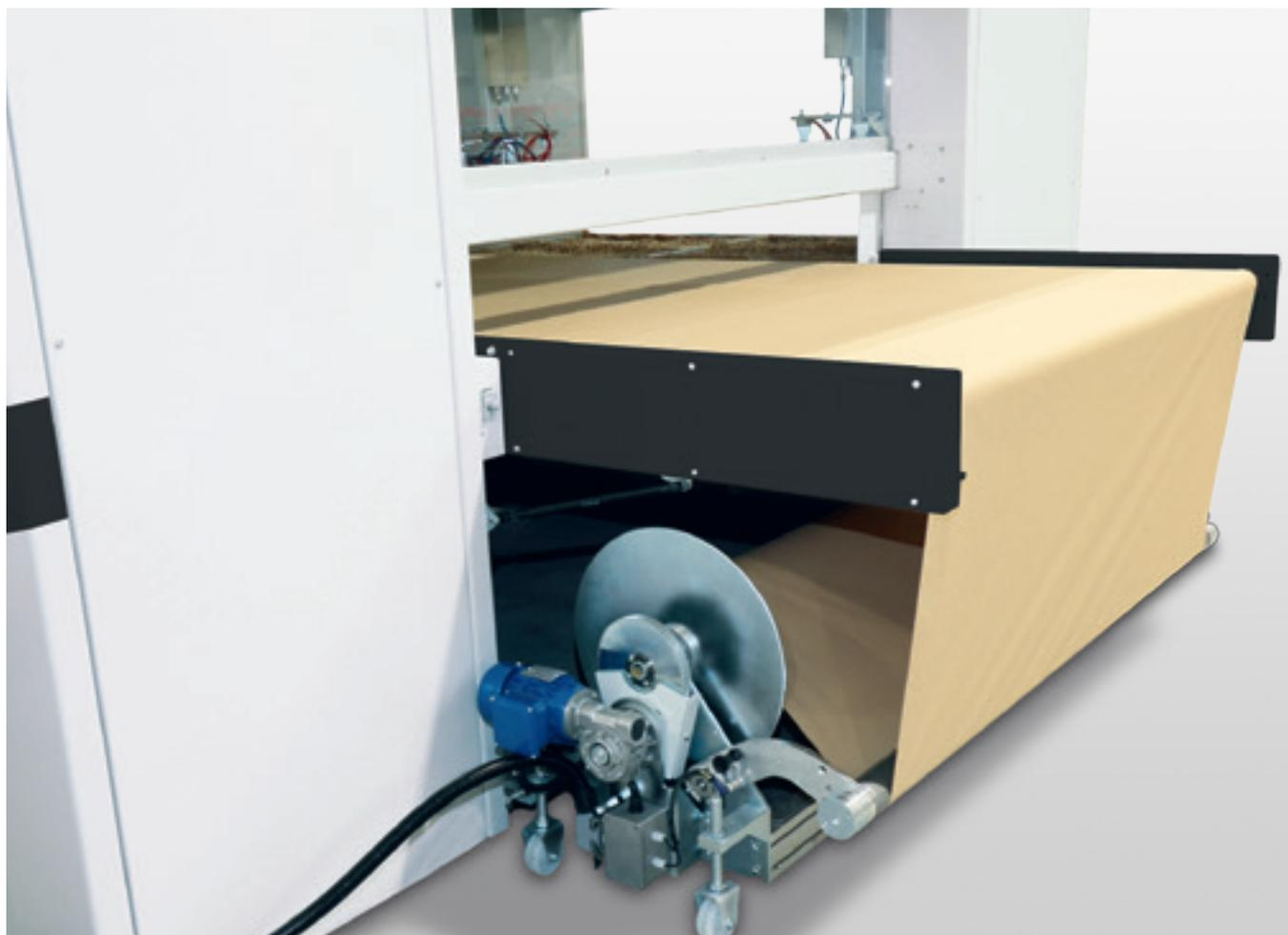
**Transport :** les pièces sont transportées à l'aide d'une bande de transport à dépression. Le papier jetable ne sert qu'au recouvrement. Ce qui permet l'utilisation de papier très fin de grande longueur en rouleau pour réduire les frais de maintenance. La tension du papier est surveillée par un capteur – avec un contrôle supplémentaire d'enroulement et de rupture du papier.
