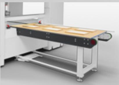
**Palettes de transport :** les pièces sont transportées à plat sur des palettes à travers la machine. Ce qui permet une manutention de pièces automatique et une commande par un seul opérateur.
