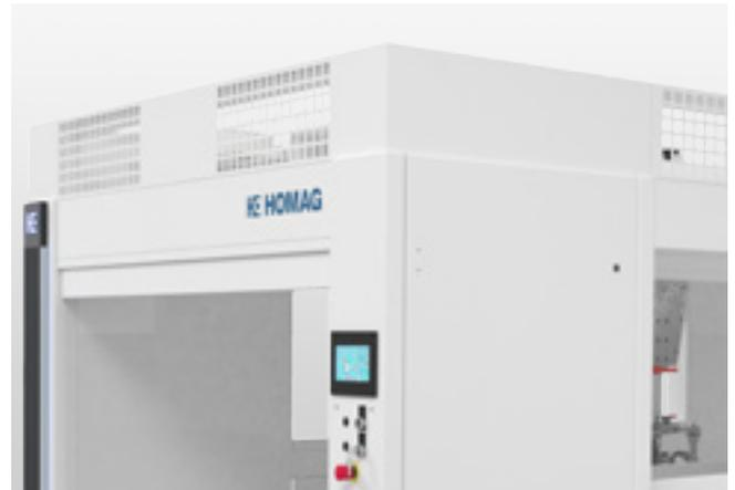
**Unité d'aération :** cette unité montée en option sur la machine de laquage optimise la répartition de l'air et la circulation d'air à l'intérieur de la cabine de laquage et assure un air sain dans la zone de laquage grâce à des filtres supplémentaires.
