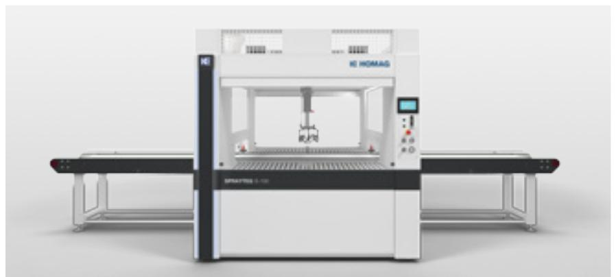
A l'aide de palettes de pièces, le laquage de très petites pièces (100 x 100 mm) est possible. Les palettes de pièces peuvent être transportées dans les deux directions. Les pièces peuvent donc être déposées et prises en charge à la même position de travail.
