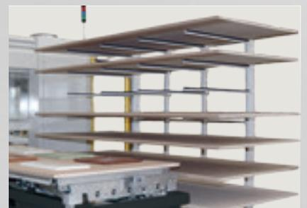
**Alimentation par chariot à glissières :** les palettes de pièces sont prises en charge de façon automatique à partir d'un chariot à glissières puis redéposées dans le chariot après le laquage.
