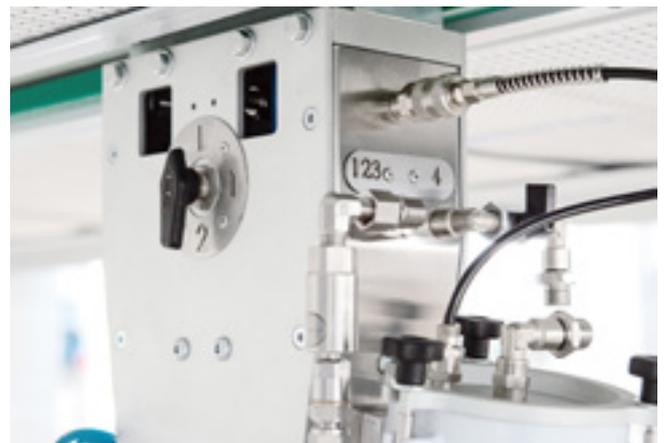
**Soupepe manuelle de changement de couleur :** cette option permet un changement de couleur simple et rapide entre un circuit de nettoyage et jusqu'à trois circuits de couleur – sans déplacement des tuyaux.
