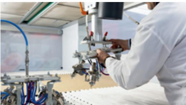
**Support de pistolet avec fermeture rapide :** une solution ergonomique et flexible pour un changement de pistolet rapide. Les supports de pistolet préparés évitent un montage et un ajustement complexes.
