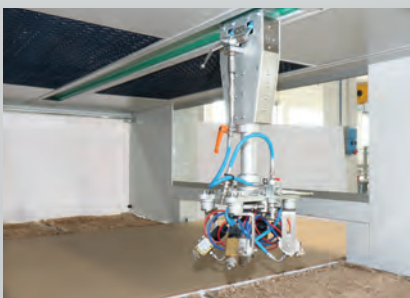
Schlittenläufer mit einem Spritzarm für vier Lackierpistolen.
