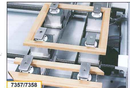
7357/7358 Schlauchlose Vakuumspanner für Rahmenteile
