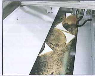
Hochsteifes Maschinenbett mit integrierter Reststück erfassung über die gesamte Bearbeitungstiefe von 1.600 mm. Es fallen keine Reststücke vor die Maschine (optional mit Späntransportband)
