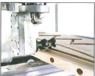
Interpolierende C-Achse 360°: Um die Aggregate in beliebigem Winkel drehen zu können, inkl. Druckluftübertragung in die Aggregate (z. B. zum Abblasen von Spanresten oder für getastete Bearbeitungen)
