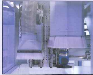
Zwei separate Z-Achsen für eine effiziente Absaugung bei geringem Energiebedarf
