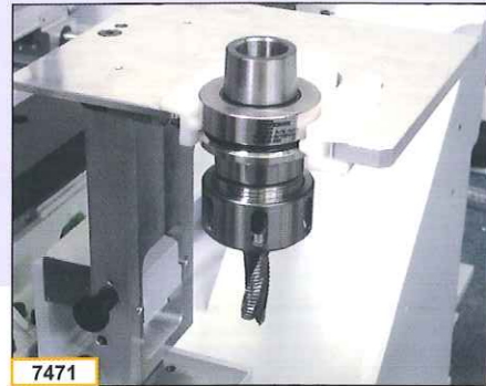
7471 Werkzeugübergabeplatz: sicheres und schnelles Beschicken des Werkzeugwechsler inkl. Leerplatzabfrage im Werkzeugwechsler
