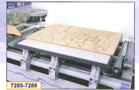
7285-7288 Matrix-Adapterplatte – für Nesting-Anwendungen und zum Spannen von Kleinteilen mit individueller Formgebung
