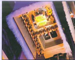
HIGH-SPEED Bohrkopf 7.500 mit 17 Vertikalspindeln, Nutsäge und vier Horizontalspindeln 0/90° schwenkbar. Ideal für die schnelle Bohrbearbeitung und das Nuten ohne Werkzeugwechsel. Einsetzbar über die gesamte Bearbeitungstiefe von über 2.000 mm
