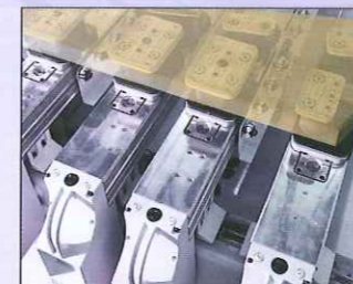
Arbeitstisch mit 8 oder 10 Konsolen und präzisen Linearführungen zur optimalen Werkstückspannung bei schwerer Zerspanung
