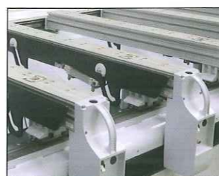
Robuste Einlegehilfen zur Auflage schwerer Werkstücke
