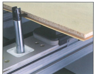
Anschlagbolzen mit klappbaren Anschlagplatten für beschichtete Werkstücke mit Deckschichtüberstand. Mit Endlageüberwachung der Anschlagbolzen zum Schutz vor Beschädigungen von Werkzeugen und Aggregaten
