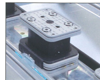
Leuchtdiodenkettens (LED) zur einfachen und schnellen Positionierung der Vakuumpspanner und Konsolen
