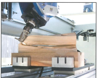
Die DRIVE5+ Fünf-Achs-Spindel bietet neue Gestaltungsmöglichkeiten, viele Optionen für die Zukunft und somit Investitionssicherheit
