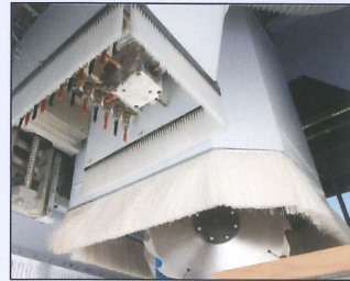
HIGH-SPEED Bohrkopf 7.500 mit 17 Vertikalspindeln, Nutsäge und 4 Horizontalspindeln 0/90° schwenkbar. Ideal für die schnelle Bohrbearbeitung und das Nuten ohne Werkzeugwechsel. Einsetzbar über die gesamte Bearbeitungstiefe von über 2.000 mm
