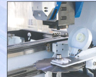
Der Pick-up-Platz für große Werkzeugdurchmesser erlaubt den Einsatz von z. B. Sägeblättern mit 350 mm Durchmesser für Kappschnitte mit bis 110 mm Werkstückhöhe. Auch bei einer Werkzeuglänge von 230 mm (inkl. HSK-Ausnahme) können Werkstücke mit bis zu 300 mm Stärke bearbeitet werden
