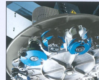
Schneller Tellerwechsler mit 18 großen Plätzen für Werkzeuge und Aggregate mit einem Durchmesser von bis zu 180 mm
