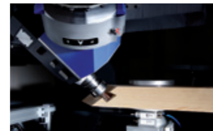
Fresata di un collegamento tra montanti e traversi
