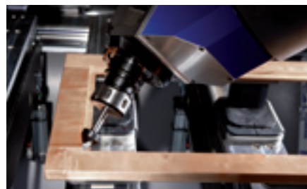
Fresata ad angolo retto su uno spigolo per la battuta del vetro
